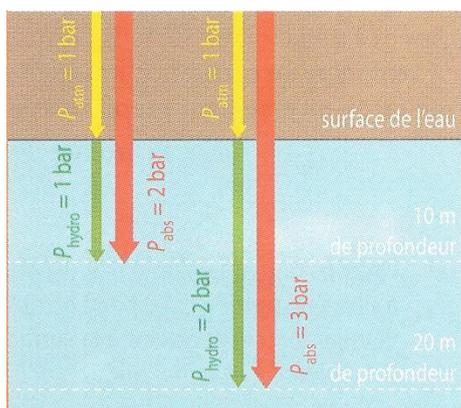
La pression absolue (ou totale)  $P_{absolue}$  à l'intérieur du liquide sera la somme de la pression atmosphérique  $P_{atm}$  et de la pression hydrostatique  $P_{hydro}$  :
