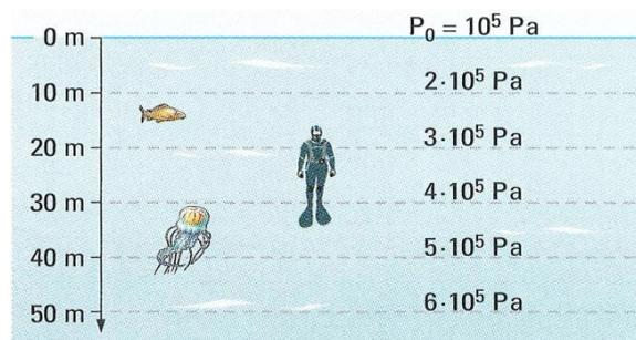
⇒ La différence de pression entre deux points d'un liquide dépend de la différence de leur profondeur.
